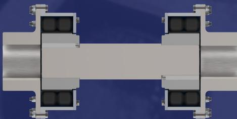
Accouplement d'arbre à cardan. Utilisé pour augmenter la distance entre les extrémités d'arbres et pour donner une capacité de désalignement supérieure.
