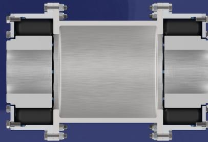
Accouplements entretoises. Utilisés pour augmenter la distance entre les extrémités d'arbre et faciliter l'accès aux machines motrices et entraînées.
